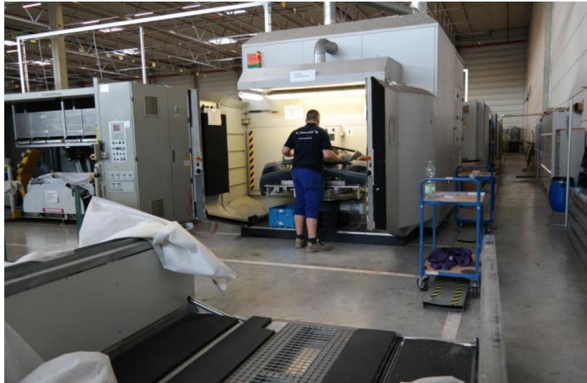
Spezielle Lasermaschinen schneiden Ausschnitte für Zierleisten und Einsätze in die Stoßfänger.
